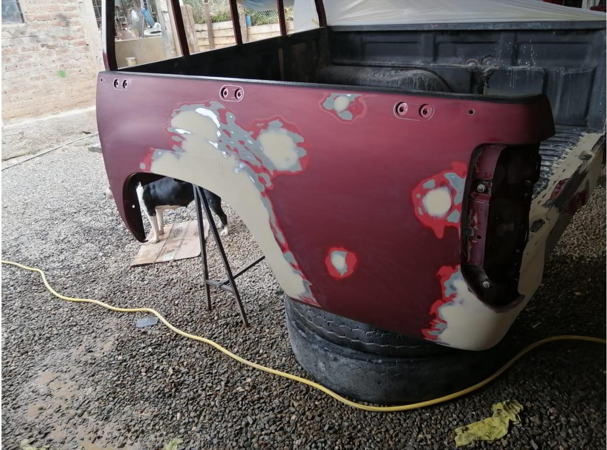
Con respecto al matizado y macillado, se procede a lijar con una lija muy fina alrededor de la superficie trabajada y área donde se va a aplicar la nueva pintura. Se usa para abrir los poros de la pintura vieja y asegurarse de que la pintura nueva se adhiera al automóvil y no exista diferencia significativa.
