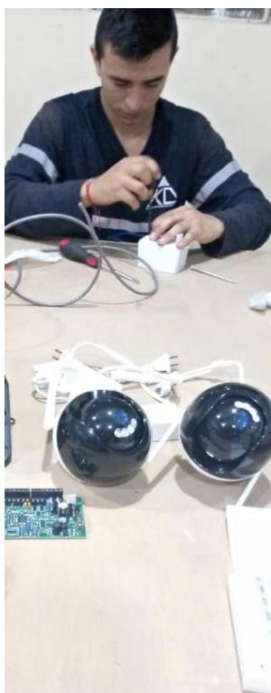
2. Colocación de tablero de fuente (TDF) para el sistema de alarma.
