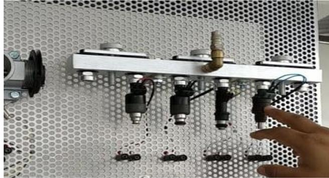
**Figura 43:** Prueba de funcionamiento de inyectores
