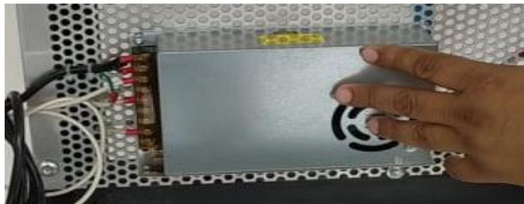
**Figura 44:** Prueba de funcionamiento fuente de poder
