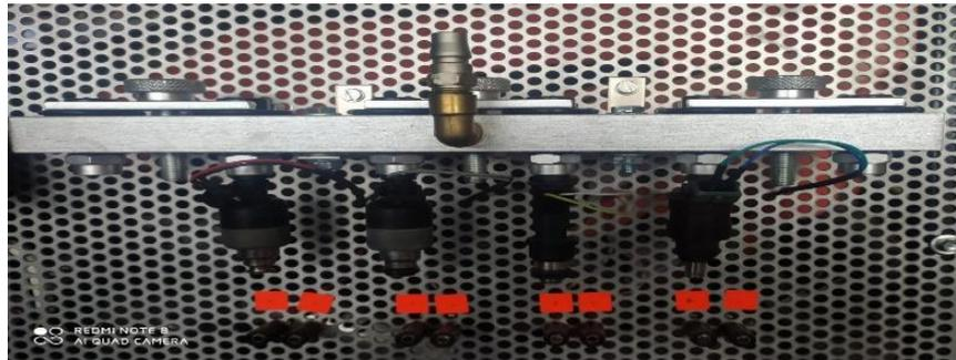
**Figura 27.** Montaje de riel de inyectores
