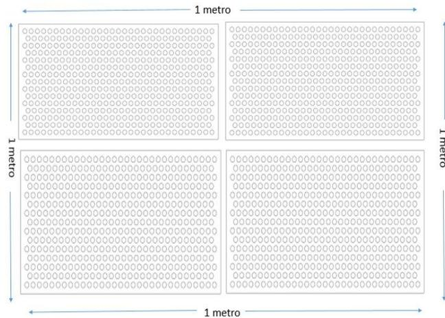
Figura 17Diseño del marco cuadrado con malla perforada
