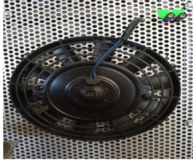
**Figura 35 . Electroventilador**
