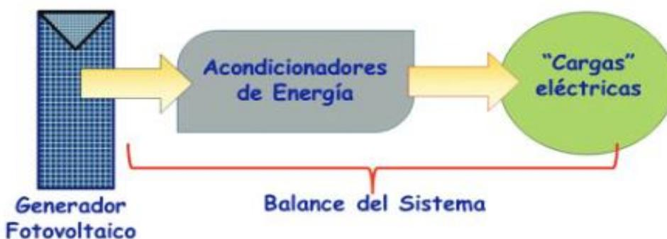
*Nota.* La imagen nos muestra un sistema de generación fotovoltaica, donde consta el generador fotovoltaico que convierte la energía solar en eléctrica; acondicionadores de energía que convierten esta energía en energía utilizable y finalmente las cargas eléctricas que representan los dispositivos que consumen la energía generada. Fuente: (Sanchez, Martínez, Santos, Ortega, & Sanchez, 2017)
