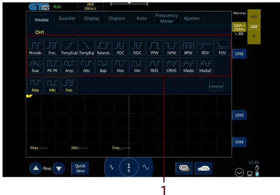
*Muestra el sistema de mediciones automáticas del osciloscopio automotriz de cuatro canales*
