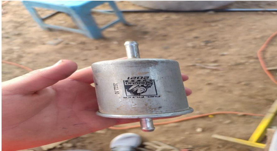
Figura 2 Filtro de Combustible.
