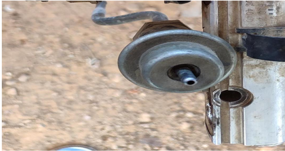
Figura 4 Regulador de presión de combustible.
