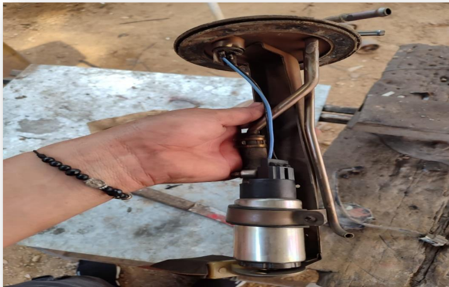
Figura 1 Bomba de Combustible del motor C22NE.
