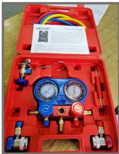
Los manómetros analógicos, están compuestos por un manómetro de alta que regularmente es de color rojo y un manómetro de baja que regularmente es de color azul, un visor de líquido, un cuerpo analizador, tomas de presión de baja y alta presión, entrada para la carga del refrigerante, mangueras con los respectivos colores y válvula para el purgado del aire.
