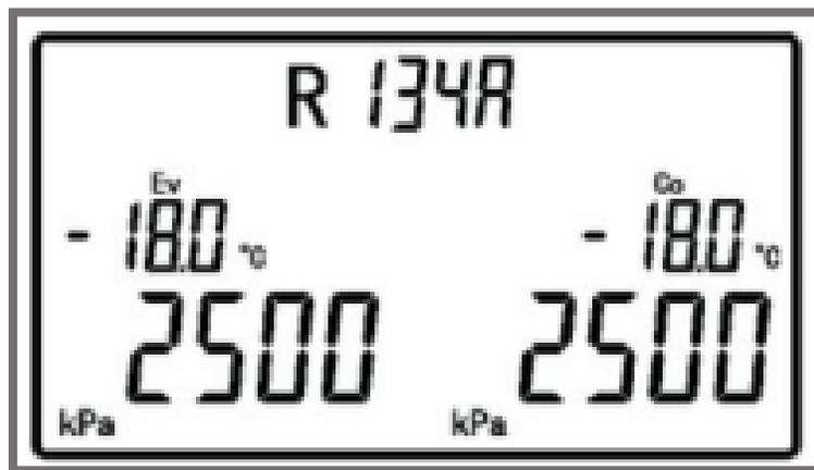
Nota: Temperatura de evaporación (EV) y condensación (CO). Tomado de: (AUTOOL, 2022)
