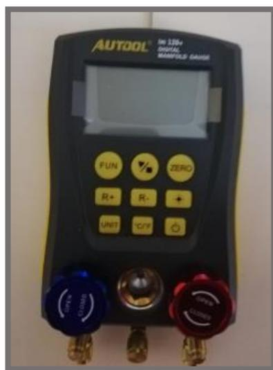
Está conformado por plásticos de alta resistencia y un diseño de silicona antideslizante flexible, toda la máquina es sólida y cómoda de sostener. La unidad de procesamiento digital es de 32 bits con precisión y estabilidad de datos obtenidos. Pantalla de cristal líquido de gran tamaño, soporte de retroiluminación LCD, pantalla de datos clara y fácil de leer. Interruptor de válvula de larga duración, diseño de interfaz estándar de 1/4 de pulgada.
