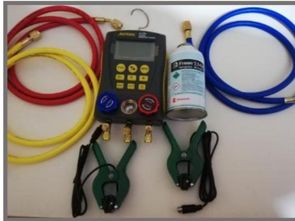
Instalación del equipo de diagnóstico y mangueras de alta y baja presión.
