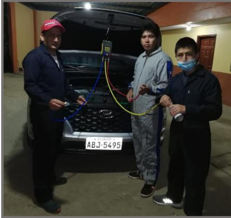
Conexión del refrigerante para introducirlo al sistema de A/C.
